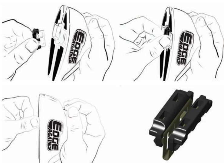
Figure 9 – Installation d'une nouvelle pièce insérable
